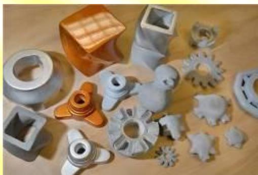
Las impresoras 3D básicamente se crearon para transformar archivos **CAD en 3 dimensiones en prototipos reales**. Del mismo modo que una impresora convencional es capaz de imprimir una hoja de papel con los esquemas realizados en un programa CAD 2D, las impresoras 3D son capaces de dar cuerpo a los diseños en 3 dimensiones.
